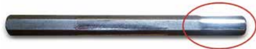
Poškozený pohon čerpadla
