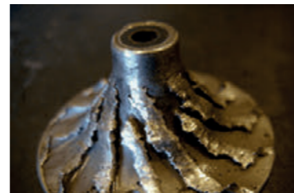
Poškození dmychadla - nasátí matice
