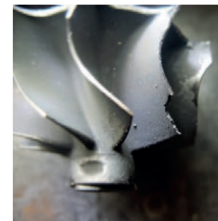
Poškození v důsledku závady vstřikování
