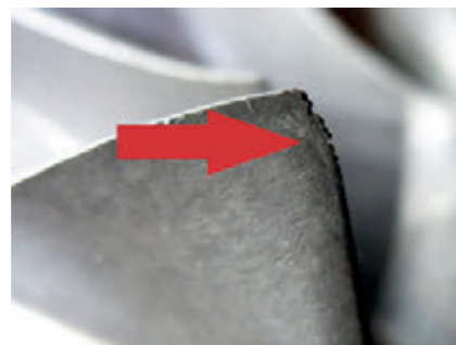
Poškození lopatek dmychadla - písek
