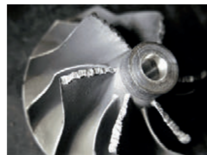
Poškození lopatek dmychadla
