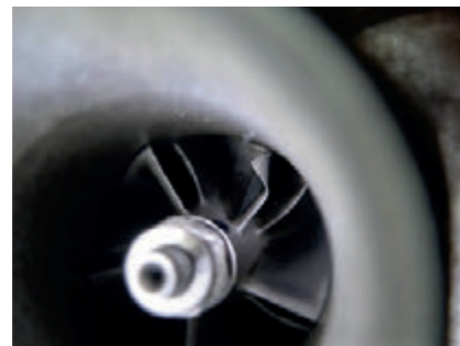
Poškození lopatky - led
